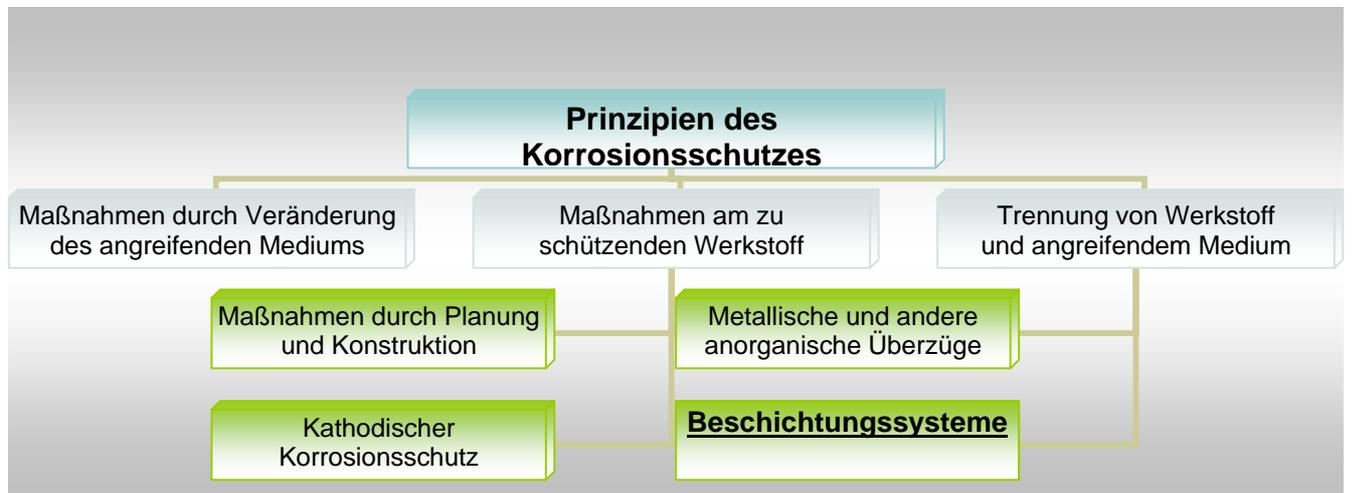
Beschichtungssysteme schützen den Stahl nicht nur vor Korrosion, sondern sie erlauben auch eine vielseitige farbliche Gestaltung von Stahlbauten in allen Bereichen.
