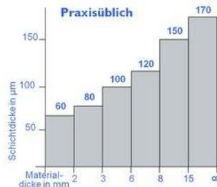
Die GreenLiner Stahlbänder in 4 mm Materialdicke enthalten eine Zinkstärke von ca. 70  $\mu\text{m}$ .
