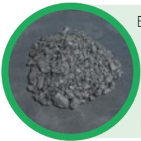
Eine ausreichend dimensionierte, verdichtete und im Randbereich entwässerte Tragschicht aus **Schotter 0/32** oder **0/45** in einer Mindeststärke von 15 cm. Je nach Frosteinwirkungszone kann es nötig sein, zusätzlich eine Frostschutzschicht von mindestens 12 cm (+5 Zone II bis 15 cm Zone III) einzubauen. (Neigung:  $\geq 1,5-2,0\%$ ; Ebenheit: 4 m-Latte  $\leq 20$  mm)
