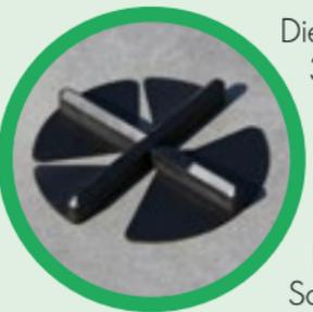
Die Verwendung von **GreenLiner® Fugenkreuz** in 3 oder 5 mm Breite ermöglicht eine geradlinige, verschubfreie Verlegung. Durch die Abstandhalter entsteht kein Kontakt der Platten untereinander. Die unterseitigen Stützplatten verhindern das Einsinken der Fugenkreuze in die Bettung und erhöhen die Lagestabilität der Platten. Durch das Abtrennen eines Schenkels lassen sich T-Stücke einfach herstellen.
